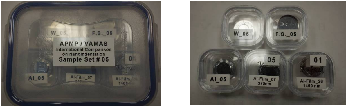
圖 2-21 奈米壓痕比對試片：鎢單晶、熔融石英、鋁塊材與兩種不同厚度鋁薄膜
