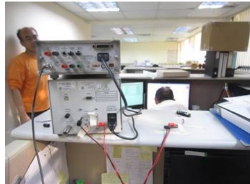
圖 1-35 FCAE 連接氣流的入口輸入標準電流源
