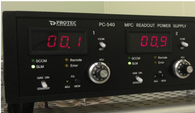
圖 2-34 氣體流量控制器由(a)單位 SLM 改為(b)單位 SCCM，總流量並由原 1 liter 降低為 100 sccm，以配合密閉腔體及試片大小的限制。
