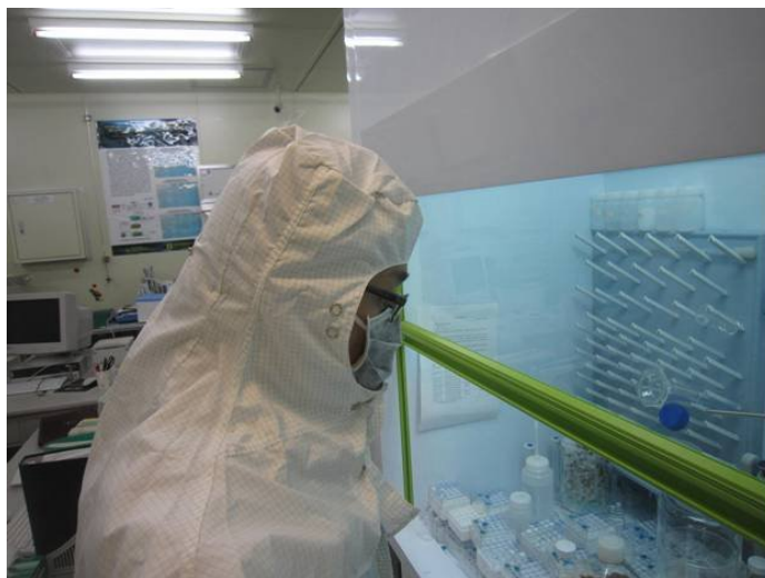
圖 1-5 進行樣品分裝之人員著裝，需配戴頭套、手套與口罩等。清洗作業的部份，樣品瓶與滴管在進行分裝之前，瓶內、瓶蓋與滴管需以純水進行內部的反覆潔淨沖洗(至少三次)。清洗後，以高壓壓縮空氣進行噴洗與乾燥。
