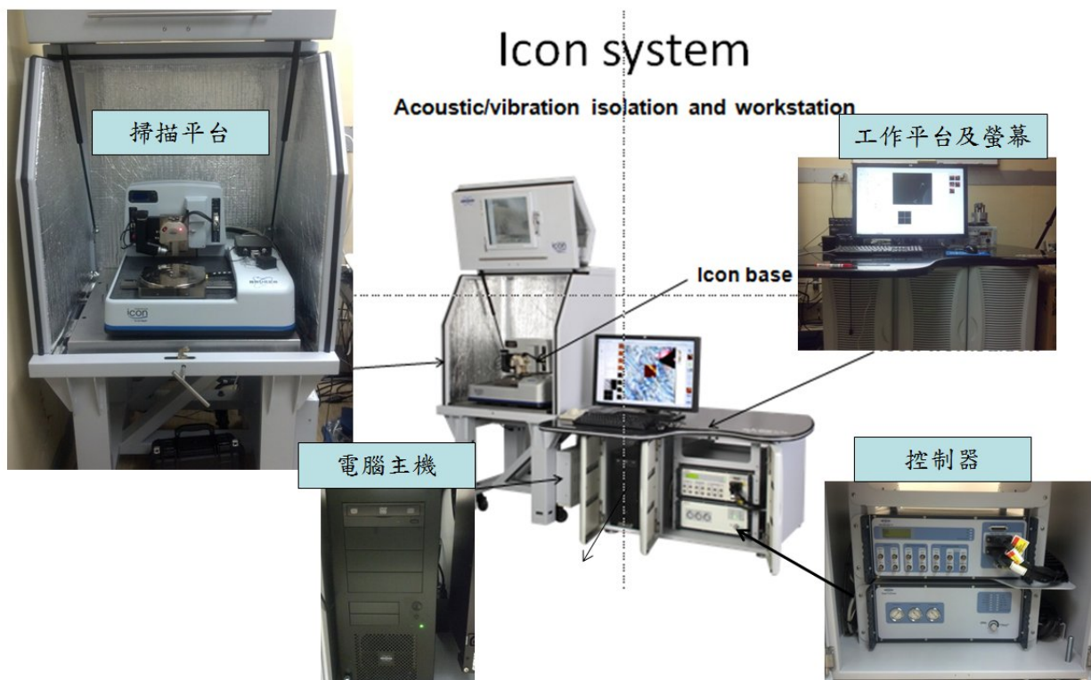
圖 2-3 側壁傾斜角的量測系統(DI 原子力顯微鏡)
