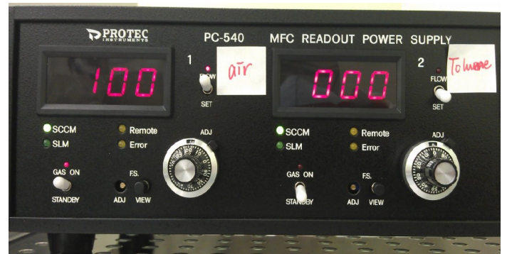
圖 2-34 氣體流量控制器由(a)單位 SLM 改為(b)單位 SCCM，總流量並由原 1 liter 降低為 100 sccm，以配合密閉腔體及試片大小的限制。
