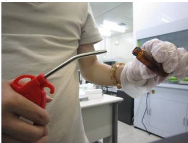
圖 1-5 進行樣品分裝之人員著裝，需配戴頭套、手套與口罩等。清洗作業的部份，樣品瓶與滴管在進行分裝之前，瓶內、瓶蓋與滴管需以純水進行內部的反覆潔淨沖洗(至少三次)。清洗後，以高壓壓縮空氣進行噴洗與乾燥。
