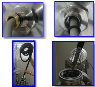
圖 1-3-13、鐘罩內部溫度計置放特殊機構
