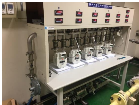
圖 3-1-1、膜式氣量計測試系統
