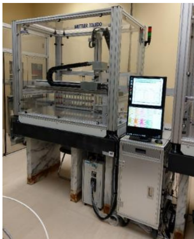
圖 1-3-25、一百克 a107XL 全自動質量比較儀量測系統實體照片
