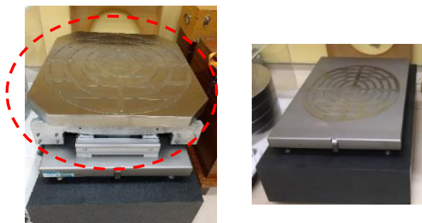
圖 1-3-5、1000 kg 自動重心調整機構
