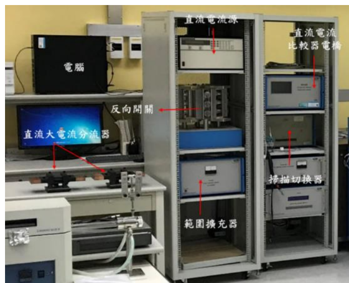
圖 1-3-36、低電阻大電流電橋系統
