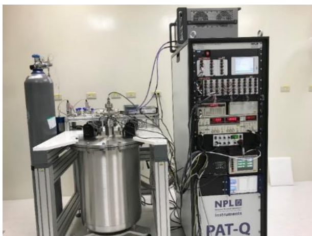
圖 1-3-30、聲學氣體溫度計量測系統
