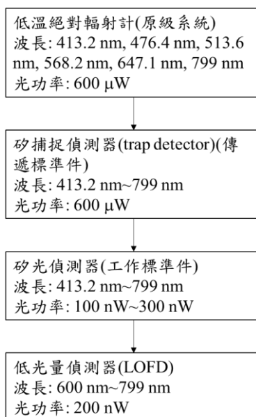
圖 1-3-19、捷克低光量偵測器之標準傳遞鏈
