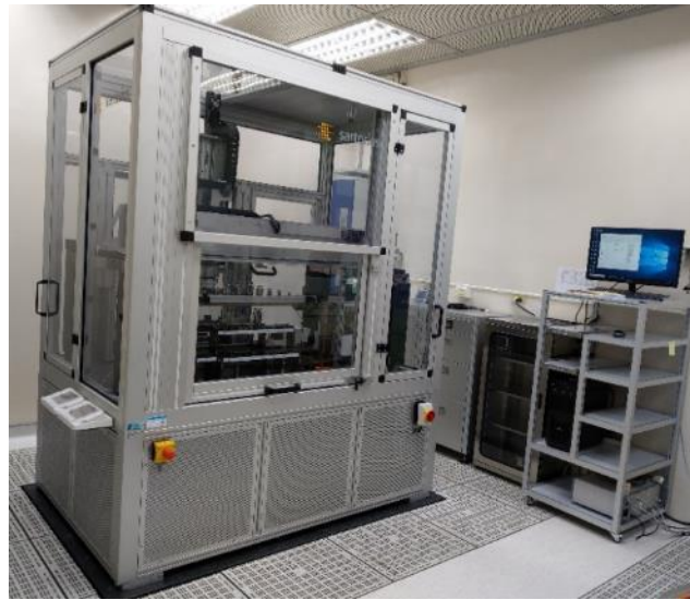
圖 1-3-24、一公斤 CCR10-1000 全自動質量比較儀量測系統實體照片
