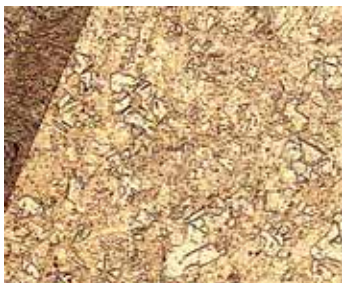
圖 1：導線本體照片(10X)
