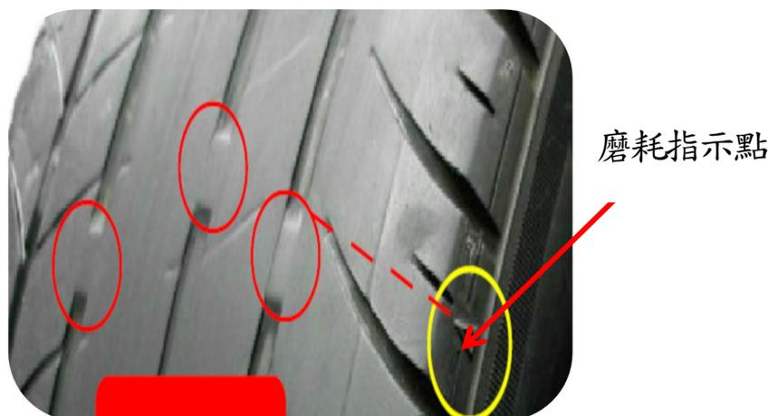
圖 4 輪胎溝紋已磨耗至指示平臺(須更換新胎)
