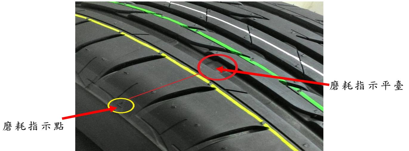
圖3 輪胎磨耗指示點及磨耗指示平臺
