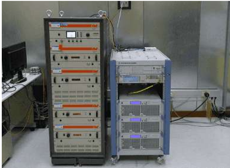
圖 133、電波暗室電磁場強度量測系統設置圖
