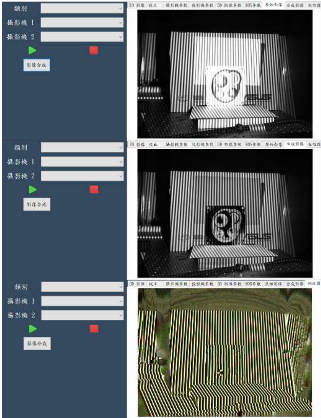
圖 44、軟體功能與人機介面，原始影像(上)、合成影像(中)、相位圖(下)
