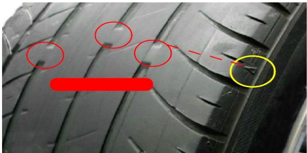
圖 3 輪胎溝紋已磨耗至指示平臺(須更換新胎)
