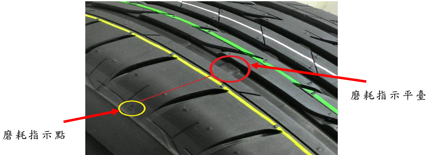
圖 2 輪胎磨耗指示點及磨耗指示平臺
