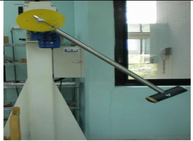
圖 4. 課椅椅背耐衝擊測試機台及衝擊錘
