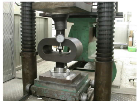
以 100 噸環式動力計校正試驗機
