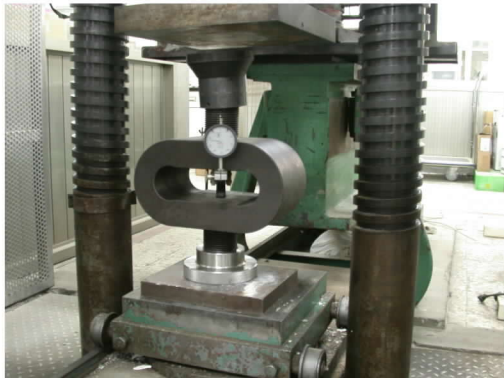
圖 1. 以 100 噸環式動力計校正試驗機
