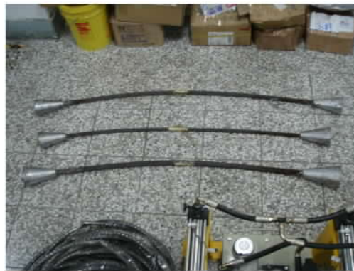
圖 1. 松和鋼鐵公司製作巴氏合金澆鑄樣品
