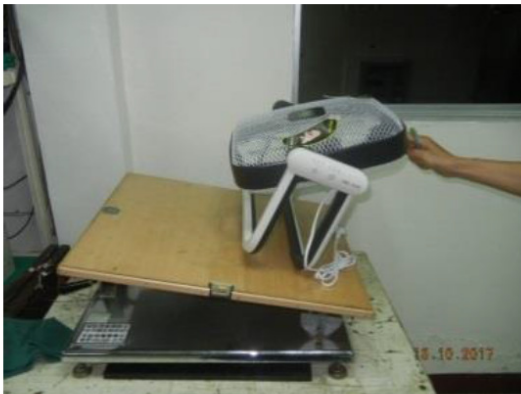
腳架未完全打開下，此角度測試 傾斜 10 度 NG)
