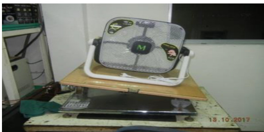
傾斜 10 度測試 OK
