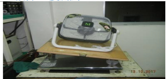
傾斜 10 度測試 OK
