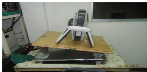
傾斜 10 度測試 OK
