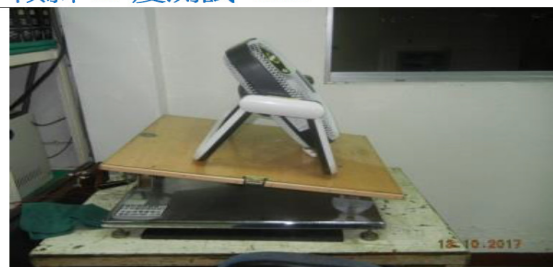
傾斜 10 度測試 OK
