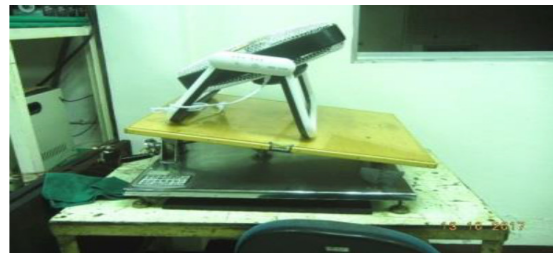
傾斜 10 度測試 OK
