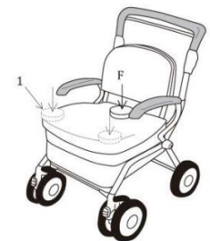
休息椅座負載時，於水平位置之穩定性測試
