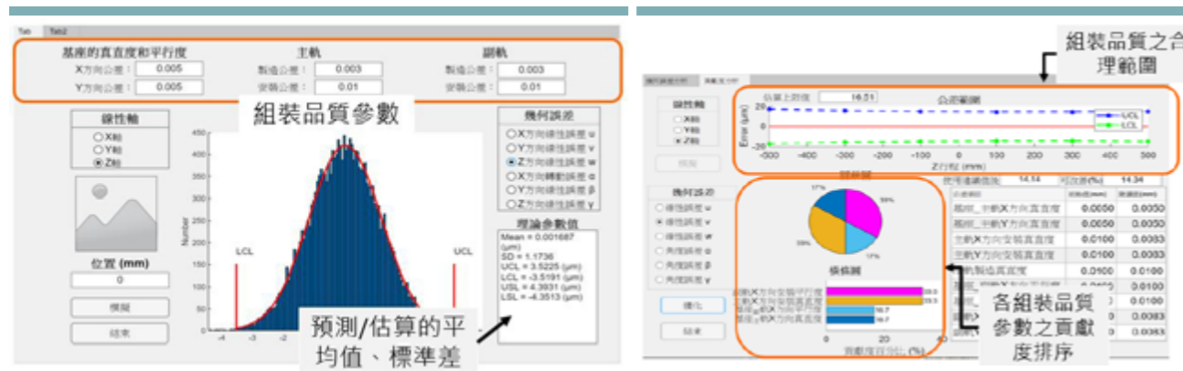
< 開發工具機關鍵組裝品質參數分析工具，縮短業者機臺除錯時間
