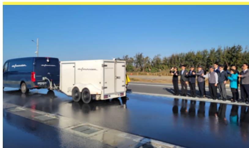
< 「濕地抓地力」跑道工程及拖車測試概況
