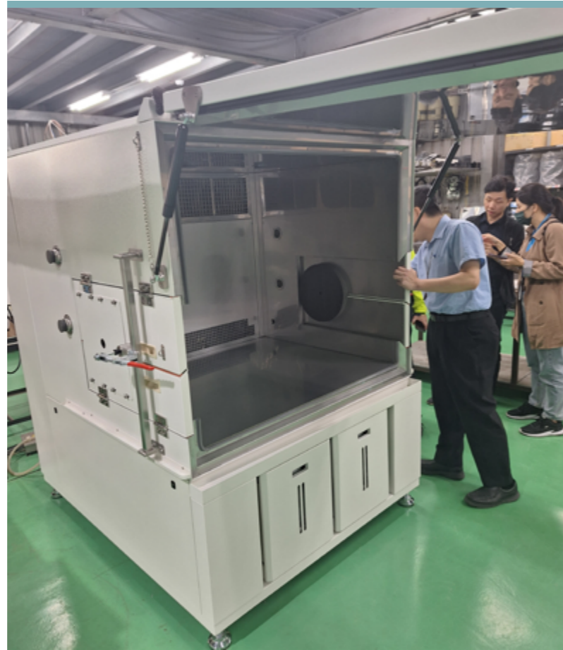
< 智慧讀表環境耐受性能（乾熱、濕熱循環）檢測能量
