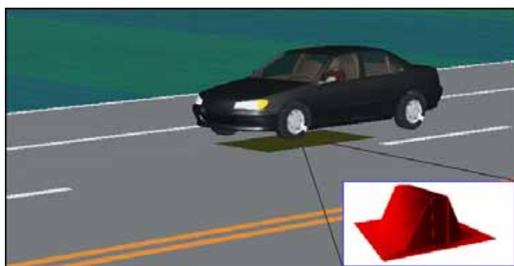
圖十七 衝擊補償邏輯於 MSC CarSim 之模擬畫面
