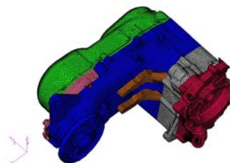
圖 7 倒角肋加強示意圖
