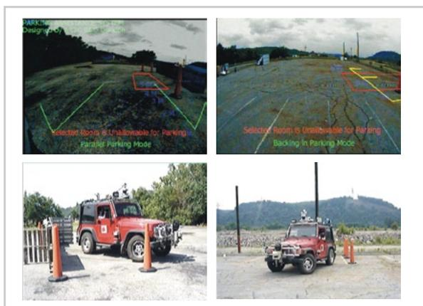
▲ 圖4. 自動停車導引系統雛形試作
