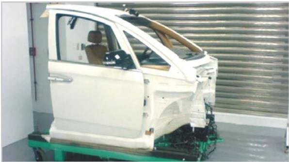
▲ 圖6. 整合車載資訊系統之Vehicle Buck
