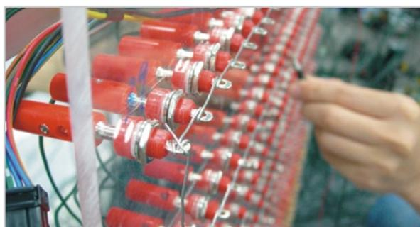
▲ 圖5. 線束絕緣測試
