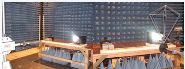
圖九 窄頻輻射干擾測試
