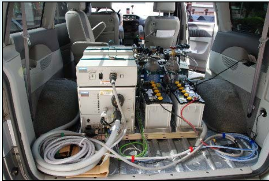
圖 1 HORIBA OBS-2200 系統實車搭載
