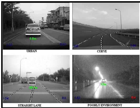
圖 5 各種天候與路況之車道偏移偵測結果
