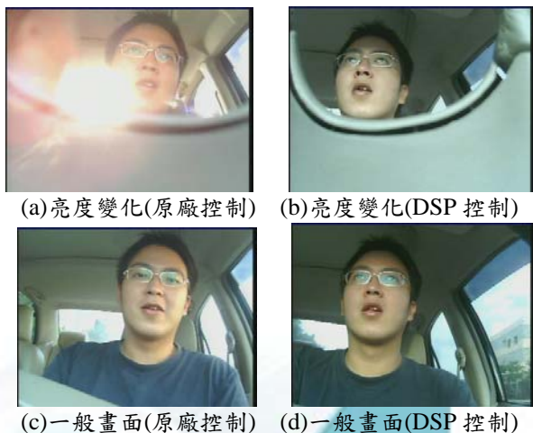
圖 20 DSP 控制 EV 與原廠控制之比較圖(室內場景)
