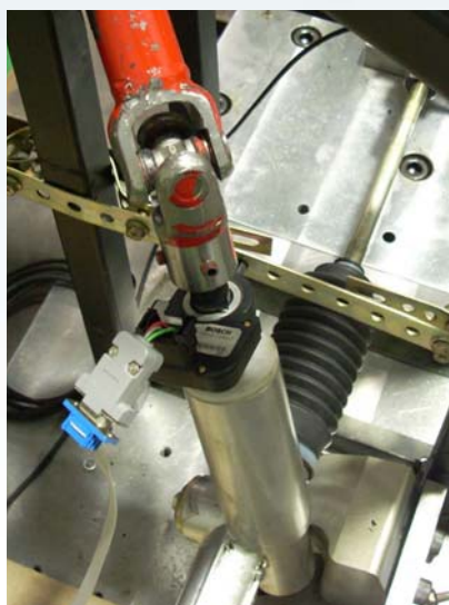
圖 6 力回饋裝置之方向盤角度感測器安裝位置
