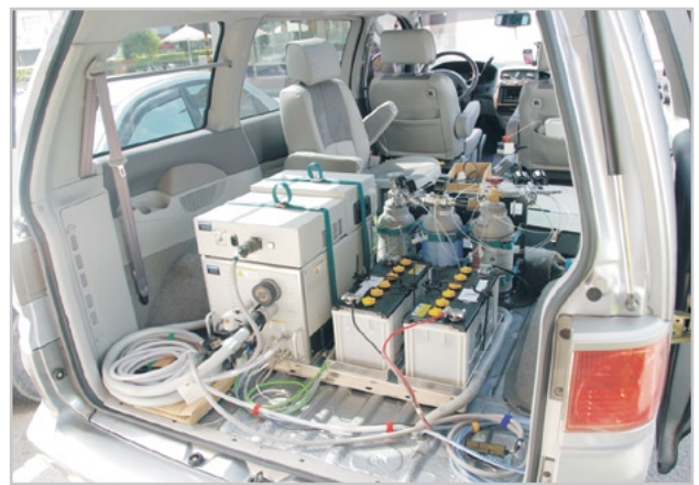
▲圖7. 實際道路車輛排放與燃油經濟性測試 (實車搭載 OBS-2200設備)
