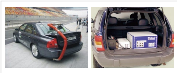
▲圖2. 車載系統SENSOR SEMTECH-D實車搭載
