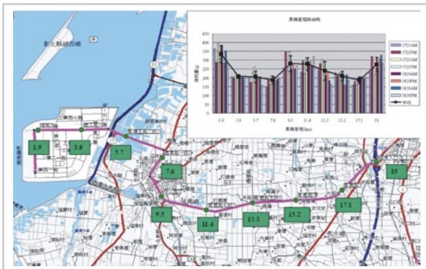
▲圖5. 透過車載配備量測排氣體積計算即時量測出行駛道路之排放量
