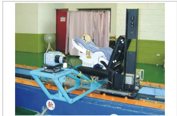
▲ 圖5. 兒童保護裝置之碰撞模擬測試
