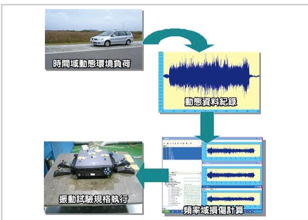
▲ 圖1. 規格轉換概念流程
