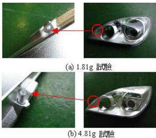
圖 5. 加速壽命試驗照片
