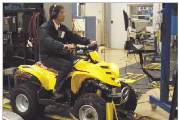
圖2 沙灘車在LOTUS實驗室完成污染相關性測試
