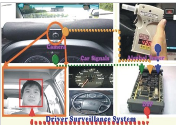
▲ 駕駛者狀態監控系統幫你監測五官，防止疲勞駕駛、酒駕等情形發生。
