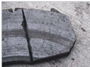
▲ 圖6. 煞車襯產生裂痕 [1]
