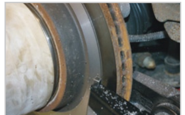
▲ 圖7. 車削碟盤表面作業 [2]
