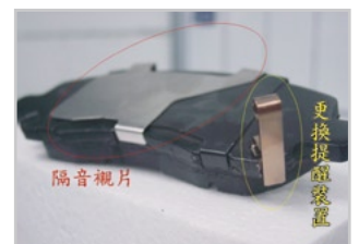
▲ 圖2. 具隔音襯片及更換提醒裝置之煞車襯
