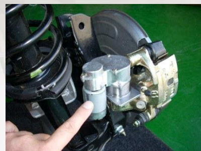
圖3 致動機構模組與煞車卡鉗的結合
