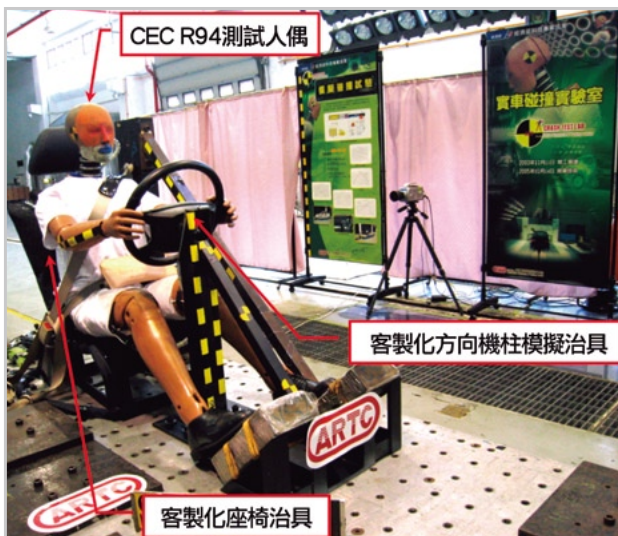
▲ 模擬碰撞—客製化束縛系統動態檢測
