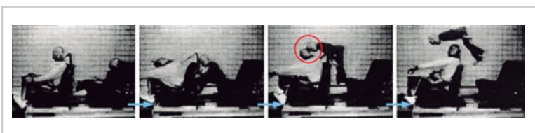
▲ 圖1、60 mph後座無繫安全帶之模擬測試
