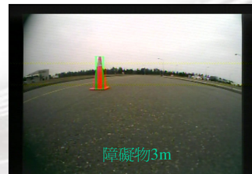
障礙物不同距離顯示不同警示訊號
