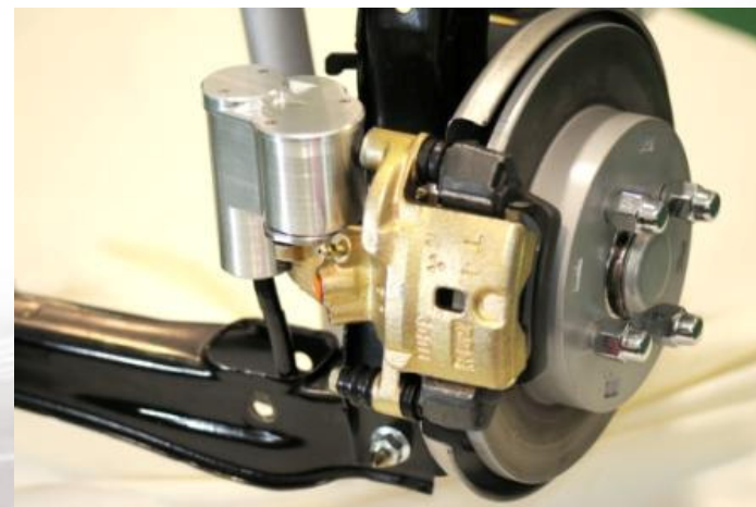
圖2 致動機構模組與煞車卡鉗的結合
