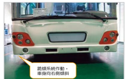
▲ 圖5、跪傾系統作動後狀態
