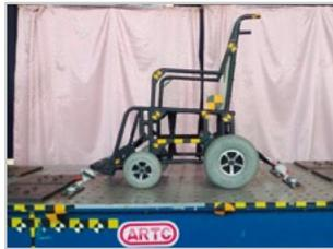
▲ 圖17、輪椅的穩定性動態測試
