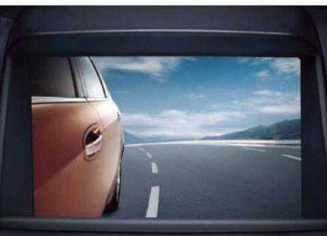
的安全系統，能在車輛行進間欲變換車道時，當駕駛者撥下方向燈撥桿後，主螢幕即自動顯示右或左後方畫面，以全彩影像呈現鏡頭向外車側範圍，以掌握視線不易察覺的死角，從容地閃避一切不可預期的危險狀況。
