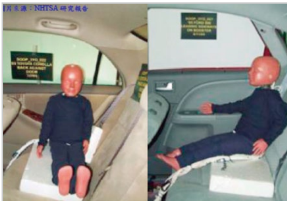
▲ 圖9、不同設定狀態之P3人偶進行乘員異位測試
