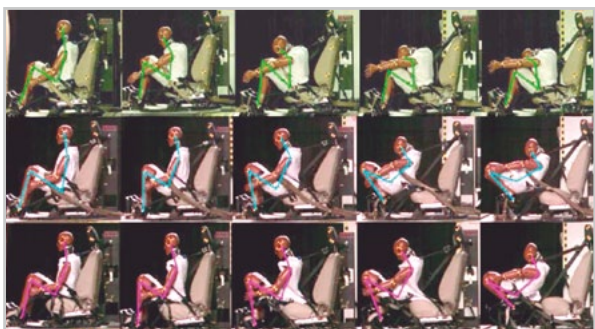
▲ 圖12、安全帶乘員異位動態衝擊測試相關研究
