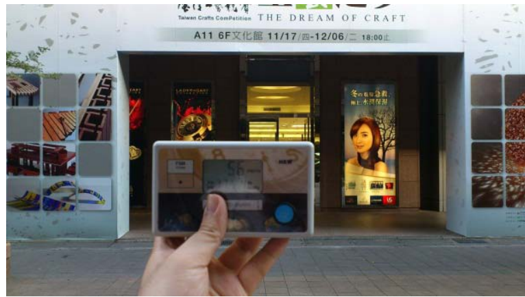
(a) 南北向，資料正確，場強 56dBuV/m
