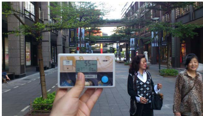
(b) 東西向，資料不正確，場強 55dBuV/m
