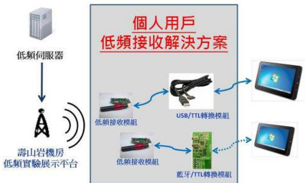
圖 2.5-1：個人用戶的低頻接收解決方案架構圖
