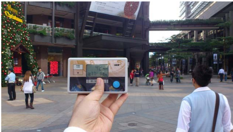
(b) 東西向，資料正確，場強 42dBuV/m
