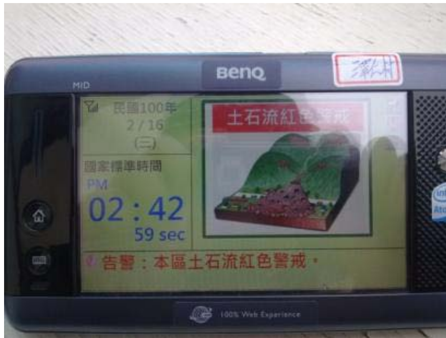
圖 2.10-3：桃園縣復興鄉土石流低頻告警示範點現場接收土石流告警情況
