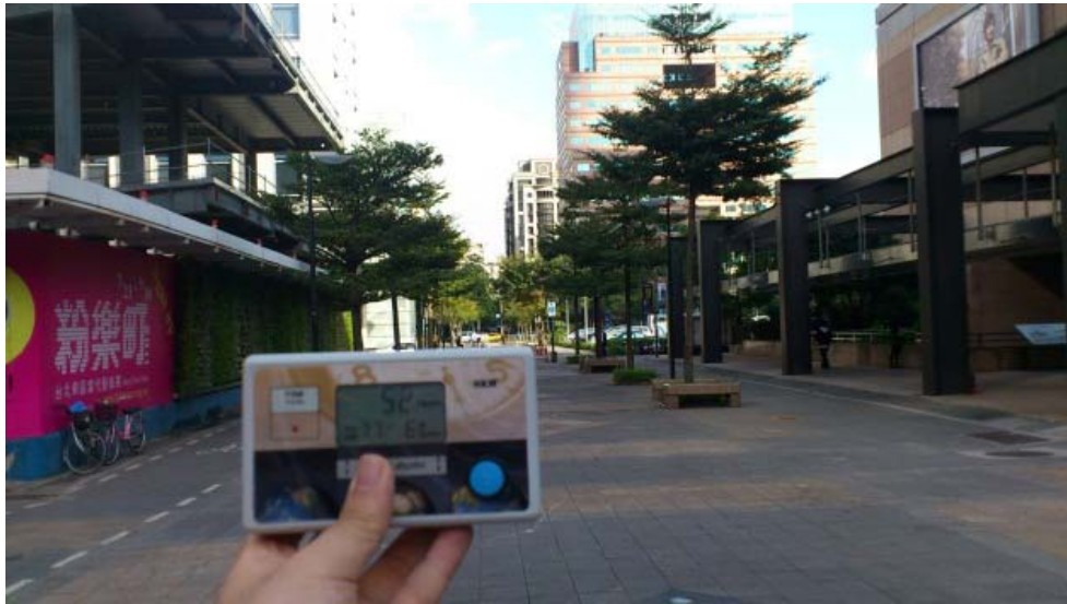
(a) 南北向，資料正確，場強 52dBuV/m
