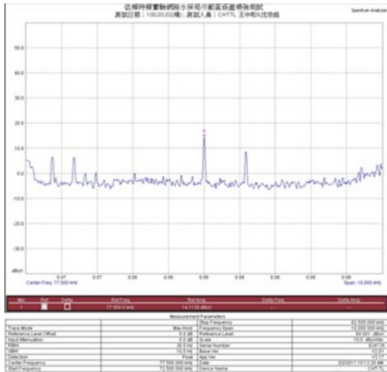
圖 2.2- 18：涵蓋測試頻譜強度圖-復興鄉民代表大樓五樓陽台
