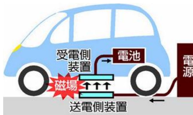
圖 1：電動車無線充電原理
