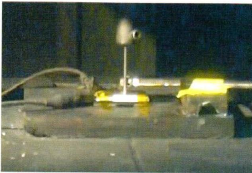
穿刺方向垂直於二次鋰單電池或電池組
