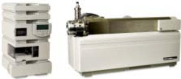
圖 1 液相層析串聯四極桿質譜儀(LC/MS/MS)
