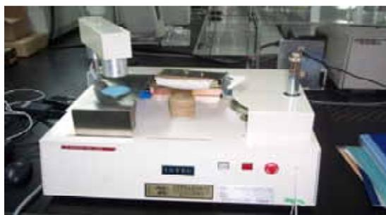
摩擦帶電之原理:原子中最外層軌道上的電子稱為價電子，若將兩種不同物體互相摩擦，由於表面的密切接觸，甲物面上的電子可能移到乙物面上，於是甲物上電子總數就少於質子而帶正電，而乙物面上電子多於質子總數而帶負電。此帶電壓測試儀即應用上述摩擦的原理。又本局具有標準溫濕度之實驗室，該設備以模擬人體穿著衣著方式而設計成；依 CNS 8312(摩擦頭使用棉布及尼龍布)及 JIS 1094(使用棉布及羊毛布)標準來測定織物摩擦後所產生的初始帶電壓與摩擦後特定時間(秒)之後的帶電壓(範圍達 20 kV、量測精密度為 $\pm 2\%$ )、摩擦後帶電壓從 5kV 量到 500v 的時間及摩擦後指定時間(秒)電壓衰減之測定，該設備可依需求不同而改變摩擦頭的摩擦頻率(通常使用 2 次/秒)，又因摩擦帶電壓收環境條件的影響甚大，該設備對測試時的溫、濕度具有監測的能力，故
