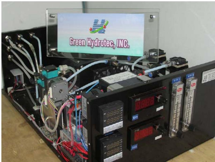
圖 4- 92 1000 lph 簡易型供氫機內部元件佈置圖
