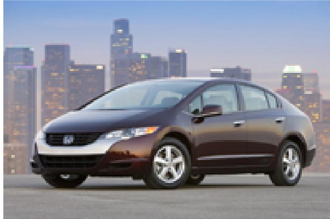
圖 4-39 本田車廠的燃料電池汽車 FCX Clarity
