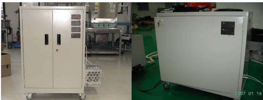
圖 4- 5 300W 燃料電池備用電源系統
