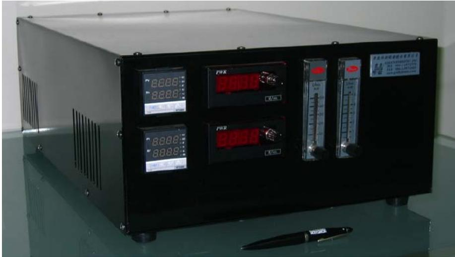
圖 4- 91 1000lph 的簡易型供氫機外觀
