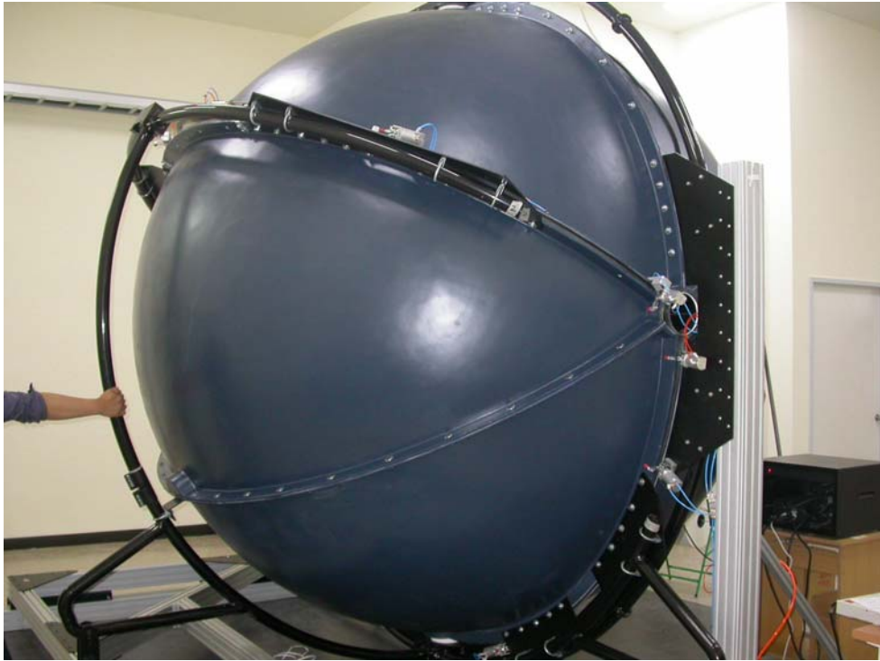
圖 7：Labsphere 3m 積分球實體圖
