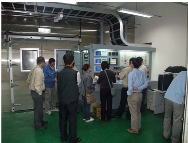
圖 40：71kW 空調機實驗室進行驗收
