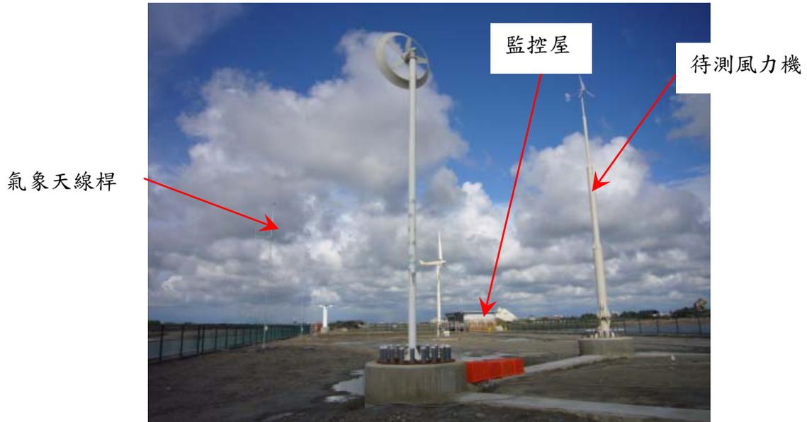
圖 7-16 風力機、風能資料蒐集設備擺放位置圖
