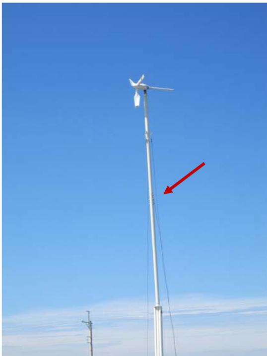
圖 7-15 09/19 日凡那比颱風來襲時，塔架彎曲 5 度情形
