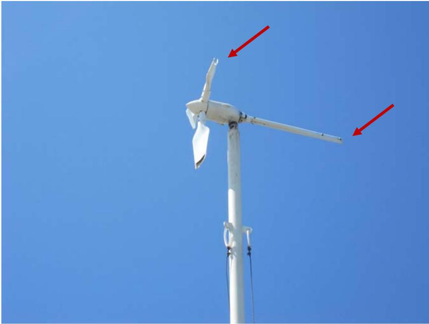
圖 7-14 09/19 日凡那比颱風來襲時，葉片及尾舵斷裂情形
