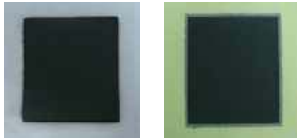
左：直接甲醇燃料電池膜電極組；右：氫氣燃料電池邊緣封裝膜電極組
