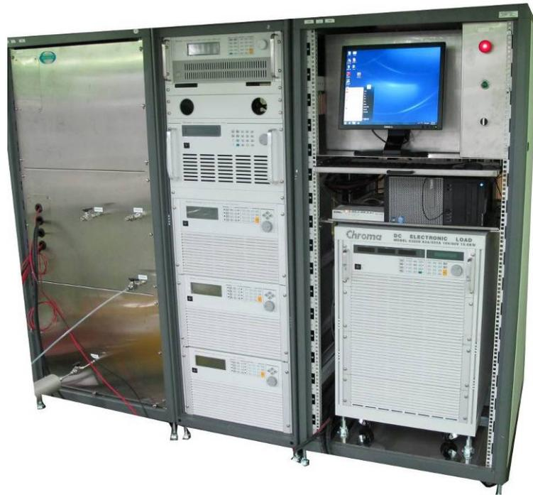
圖 81 10 kW 燃料電池發電系統
