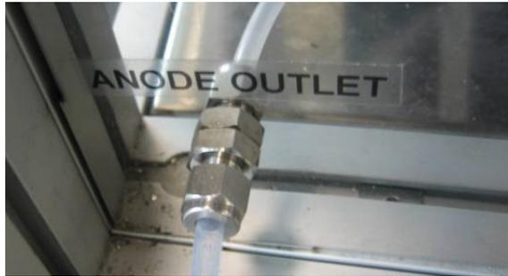
圖48 (h) 測試機台之陽極燃料供應回收端
