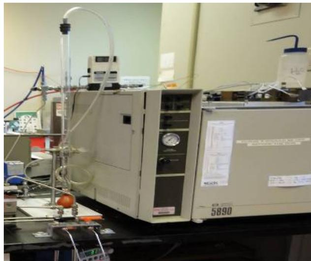
圖 101 氫氣重組器檢測設備(三)GC 分析儀
