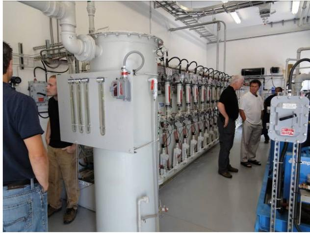
圖 107 水電解製氫設備
