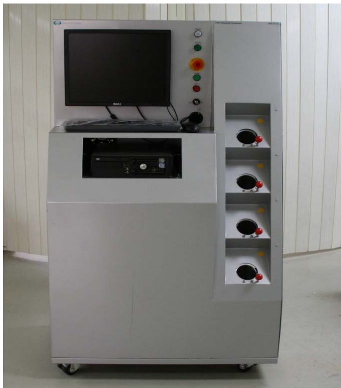
圖 4- 71 儲存充氫檢測儀器(HSCCT-4)
