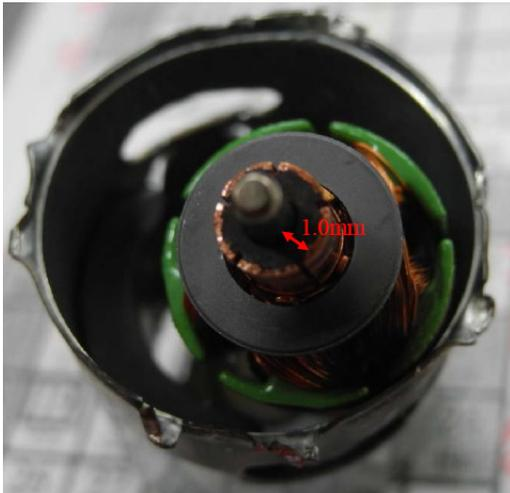
圖 2 帶電部與軸心距離
