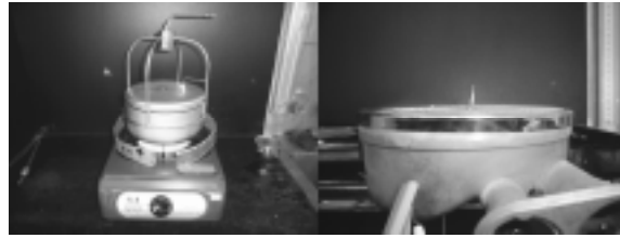
蓄熱體周圍加遮罩 蓄熱體表面火環
