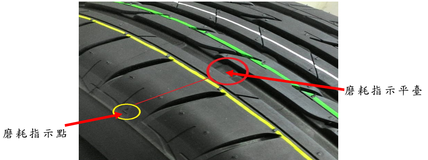
圖3 輪胎磨耗指示點及磨耗指示平臺
