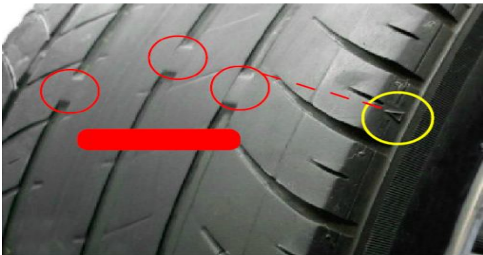
圖 4 輪胎胎紋已磨耗至指示平臺 (須更換新胎)
